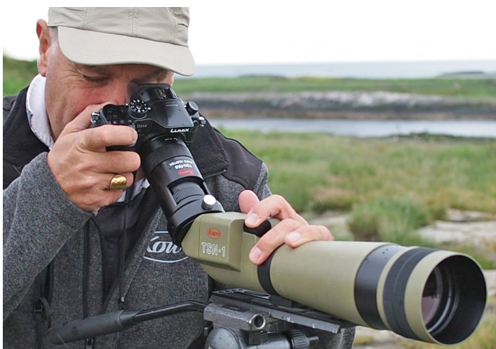
Digiskopieren mit einer aktuellen Digitalkamera und einem KOWA TSN-1 Spektiv
